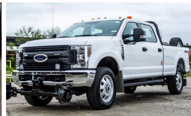
Renovación de equipos Especializados (Hi-rail)
